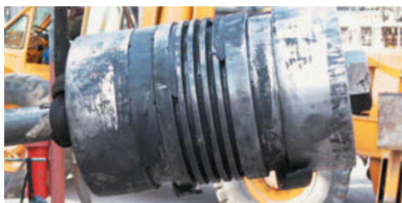
Danneggiamento del pistone
