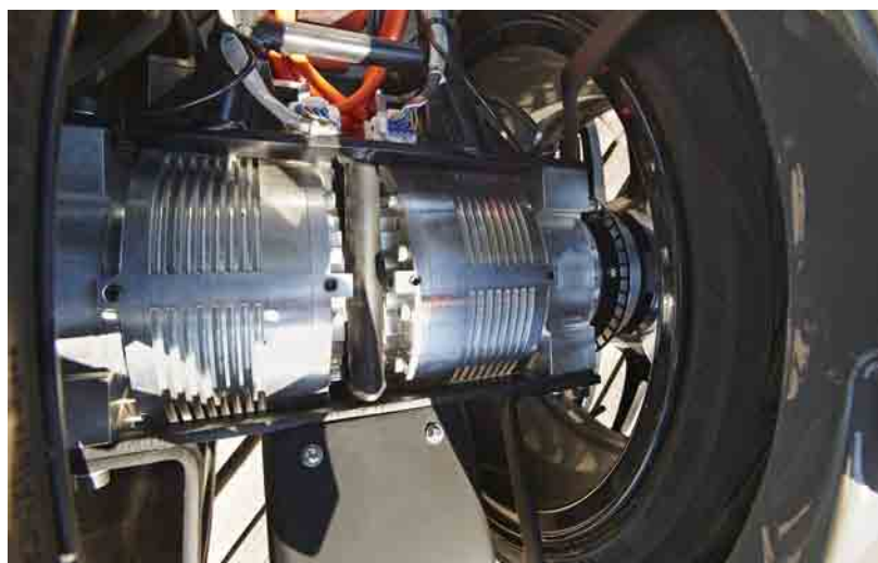
Il motore elettrico E-Wazuma sviluppato da NTN-SNR offre una nuova visione della tecnologia "in-wheel motor system" con due motori da 30 kw ciascuno integrati nelle ruote posteriori gemellate
