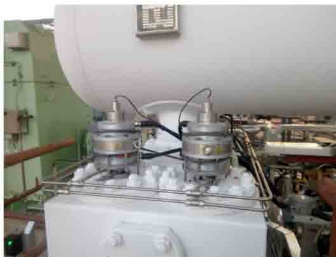
Figura 1a e 1b - schema F2F e attuatori sul cilindro
