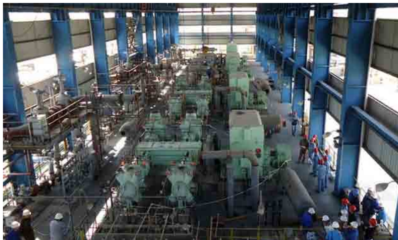
Figura 2 - Compressori alternativi in raffineria
