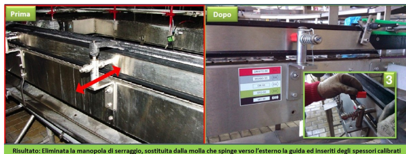
Risultato: Eliminata la manopola di serraggio, sostituita dalla molla che spinge verso l'esterno la guida ed inseriti degli spessori calibrati
