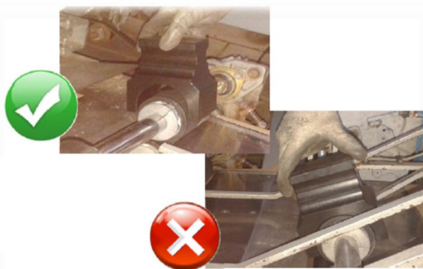
Figura 4 - Esempio di Poka-Yoke per la misurazione dell'usura dei rulli di lancio di un Incartonatrice. Nell'ambito del programma di sviluppo e trasferimento delle competenze, questa attività di ispezione, che diviene semplice ed a prova di errore, è stata trasferita al livello operatore
