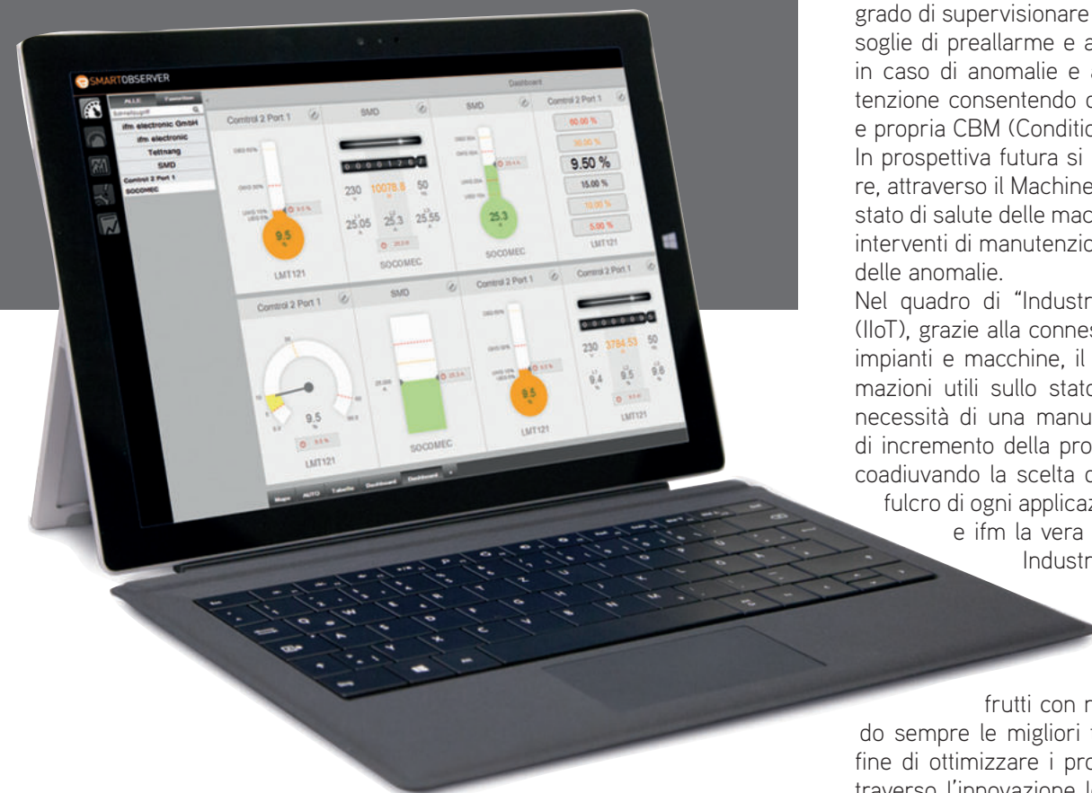
I risultati sono trasmessi, mediante connessione Ethernet, al software di supervisione ifm Linerecorder SmartObserver
