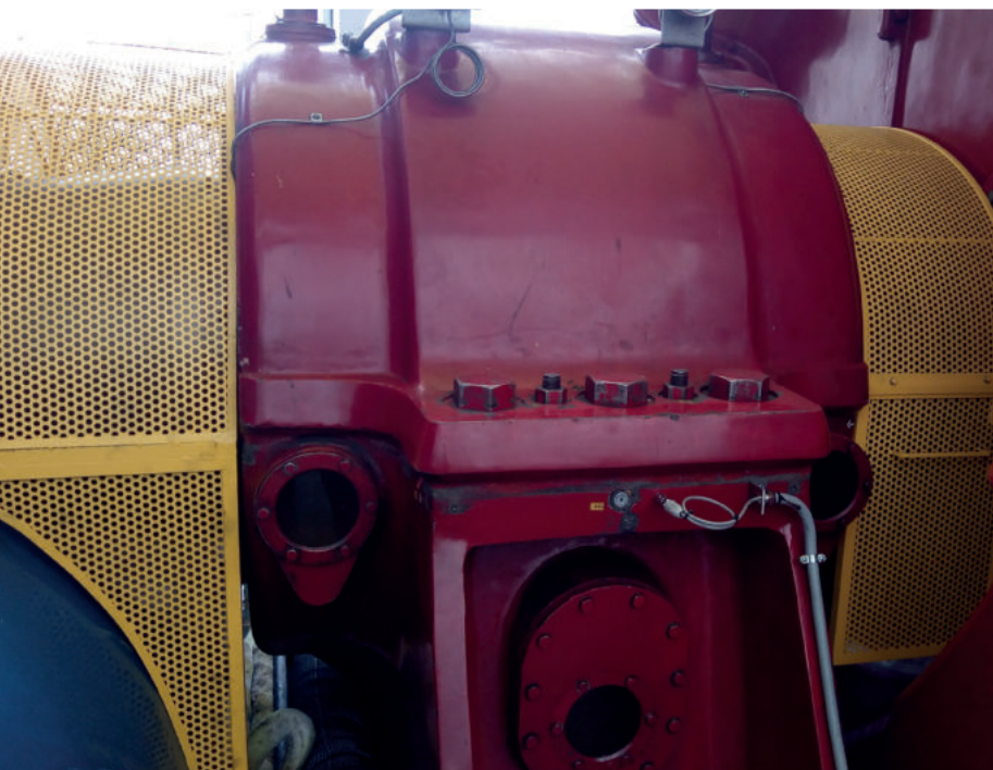
Accelerometro ifm VSA001 applicato in campo radiale rispetto all'asse di rotazione
