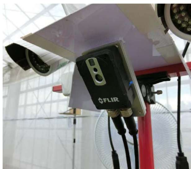
La termocamera FLIR AX8 osserva continuamente la condizione delle colture
