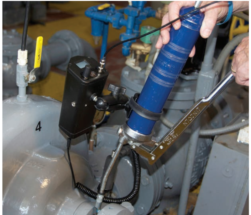
Il monitoraggio avviene montando il Grease Caddy sulla pistola ingrassatrice
