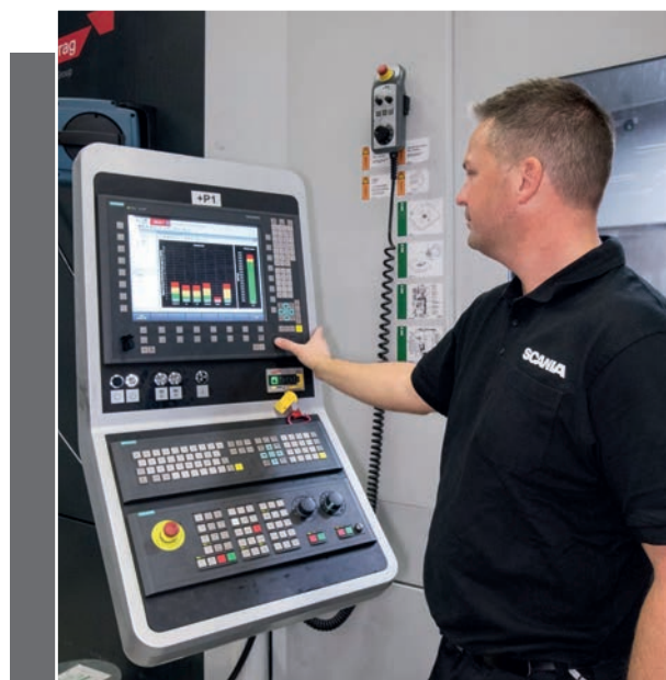
Robert Bergkvist controlla i dati del sensore: «Il software diagnostico ci mostra le condizioni dei mandrini segnalando se è necessario adattare i parametri di processo»
