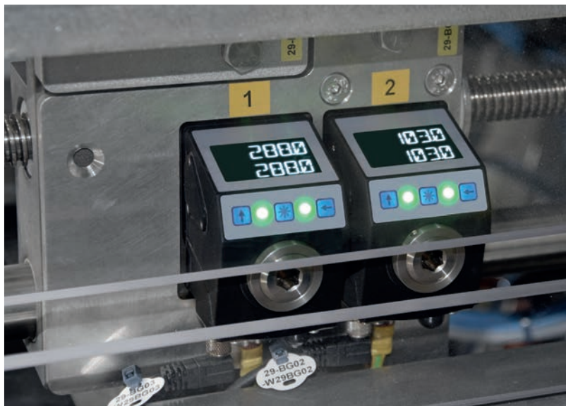
Indicatori di posizione elettronici AP10 di Siko per i cambi di formato. I LED di stato si illuminano di verde, poiché il valore nominale e il valore effettivo corrispondono esattamente. ©Rovema GmbH
