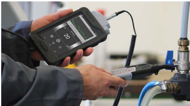
Il rilevatore SONAPHONE è capace di rilevare gli ultrasuoni nella banda 20-100kHz e mostra lo spettro sullo schermo touch a colori, aiutando il manutentore nell'individuazione della perdita
