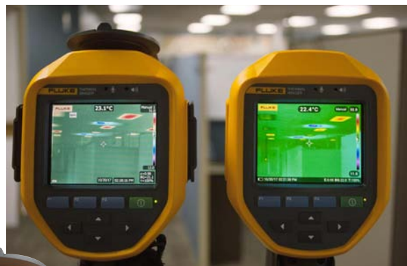
Confronto schermi tra le termocamere Fluke Ti450 e Ti450 PRO
