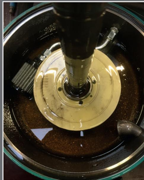
*Nella base del filtro sono chiaramente visibili i segni del livello di alta contaminazione dell'olio. Pezzi di metallo sufficientemente grandi da stabilizzarsi per gravità nel filtro grazie al flusso relativamente basso documentano le condizioni di usura estremamente alte del cambio gravemente danneggiato*
