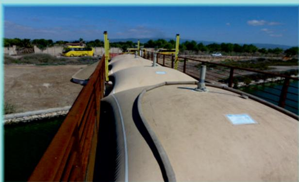
La quantità di acqua immessa determina il carico al mq. Una volta terminate le prove viene svuotato attraverso lo scarico e può essere facilmente arrotolato per lo stoccaggio.
