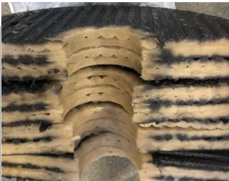
*Inserto del filtro di profondità dopo 18 mesi di filtrazione fine, ancora non saturo. Tempo di servizio del filtro maggiore del 30-50% grazie alla capacità di trattenimento dello sporco estremamente elevata*
