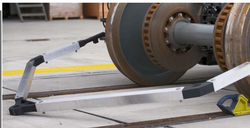
Siemens Mobility ora utilizza la Fortus 450mc per realizzare strumenti unici personalizzati per ogni carrello in poche ore
