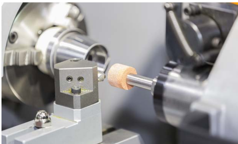
Nel processo di fresatura gli azionamenti dei mandrini e il diamantatore della testa devono girare con la massima fluidità e precisione
