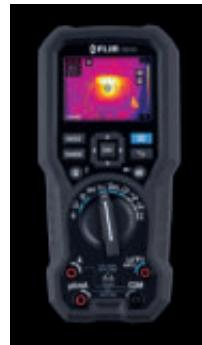
che consente di utilizzare la funzione MSX anche in condizioni di scarsa illuminazione. L'imaging MSX è additivo e sovrappone i dettagli dei contorni dello spettro visibile all'immagine termica senza sacrificare risoluzione o dettagli termici.
