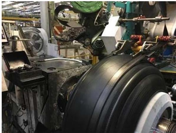
*Nello stabilimento di Spinetta Marengo lo pneumatico si muove sui Conveyor e viene manipolato in produzione ad una velocità di 0,40m al secondo, 24 m al minuto*
