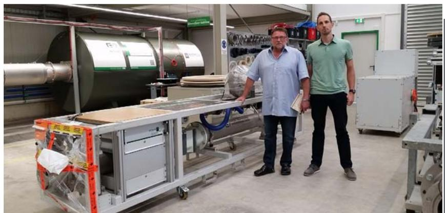
*Nel nuovo stabilimento il fondatore dell'azienda Alois Ehrler e l'amministratore Oliver Hammel presentano un sistema di misura e taratura della portata per sistemi di misura dell'aria aspirata dotato di un misuratore di portata volumetrica a ultrasuoni FLOWSIC*
