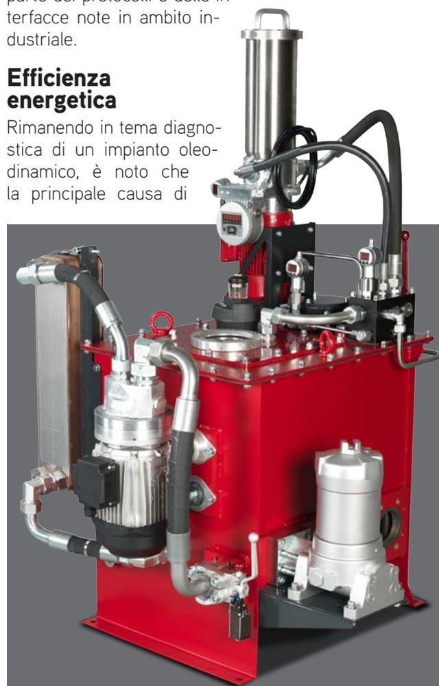
*OXI-Stop è uno speciale serbatoio a membrana flessibile che, dotato di opportuni sistemi di degasing e dewatering, permette di avere in serbatoio la quantità d'olio strettamente necessaria alle richieste operative d'impianto*
