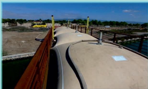
Ideato appositamente per essere impiegato come carico per le prove di solai e strutture portanti. Costruito con tessuto poliestere extra-forte rivestito con plastomeri, a forma a cuscino, viene riempito d'acqua attraverso un bocchettone di carico.
