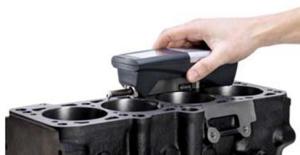
re 28 parametri differenti di superficie tutti conformi alle più recenti normative. Le caratteristiche dei modelli HANDYSURF+ li rendono adatti a essere utilizzati in diversi settori dell'industria.
