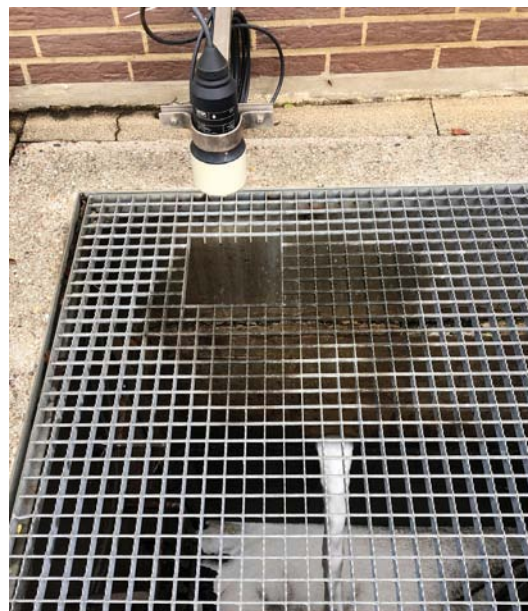
Grazie all'ottima focalizzazione del segnale, lo strumento di misura di livello installato sopra al pozzetto effettua la misura in maniera affidabile nonostante la presenza della scala
