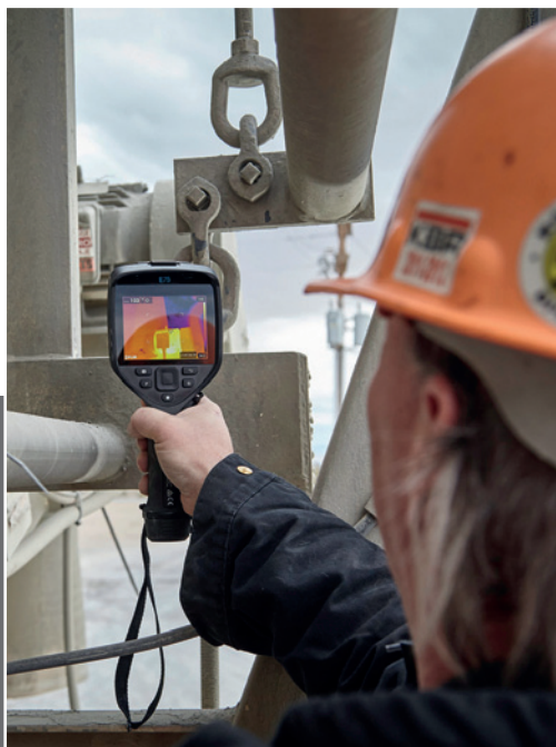
Il personale addetto alla manutenzione può utilizzare la termografia per valutarne la protezione contro gli agenti atmosferici e contribuire a rendere l'edificio meno permeabile e migliorarne l'efficienza
