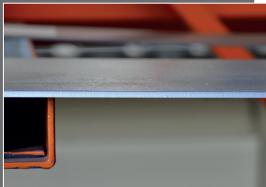
Grazie ad OD2, X-Cut è in grado di tagliare solamente le lamiere con spessore conforme nel caso in cui venga preimpostata questa variabile, oppure si autoprogramma in base allo spessore dei materiali inseriti, anche con finiture diverse tra loro, senza alcuna interruzione del ciclo di taglio
