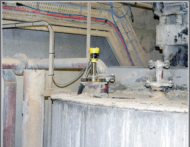
Il sensore di livello radar a 80 GHz VEGAPULS 64 di VEGA misura con precisione il livello sul bordo del serbatoio di miscelazione del latte di calce
