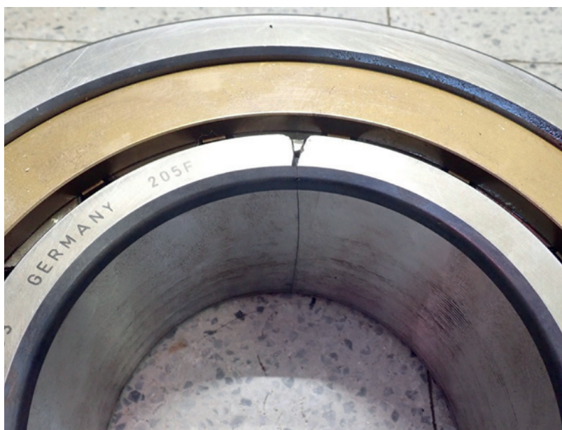
Figura 1c - Danneggiamento anello interno cuscinetto dell'HSS
