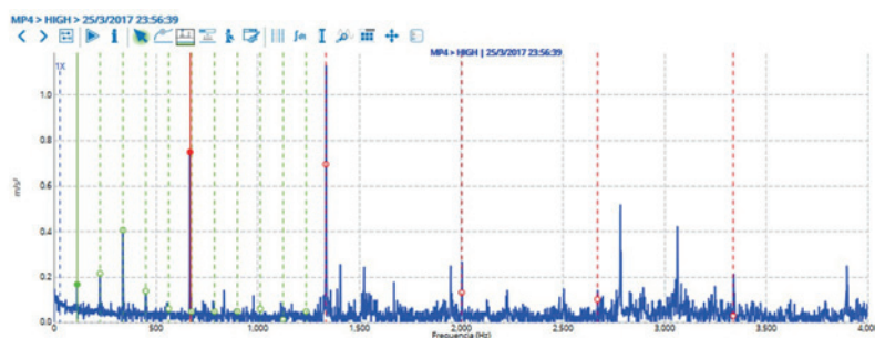
Figura 1a - Spettro 0-4000 Hz misurato da accelerometro in prossimità dell'albero HSS - condizione meccanica normale
