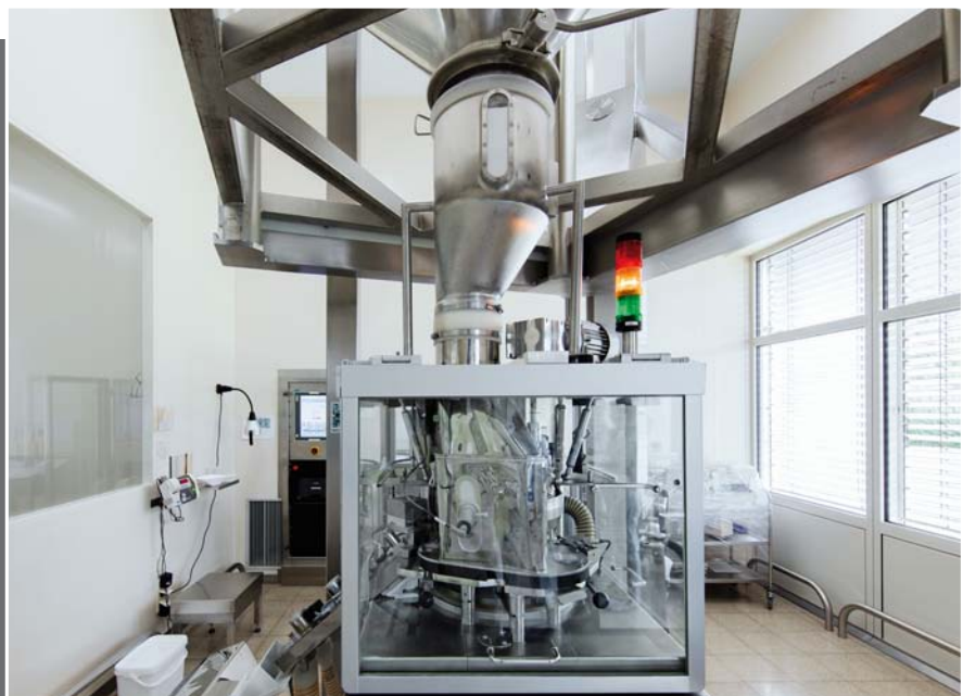
Figura 1 - ACSR-Solutions ha già modernizzato due presse per pastiglie di Aesica Pharmaceuticals e le ha dotate, con il suo controllore TabControl, di un equipment con garanzia. Per il futuro sono in previsione ulteriori modernizzazioni
