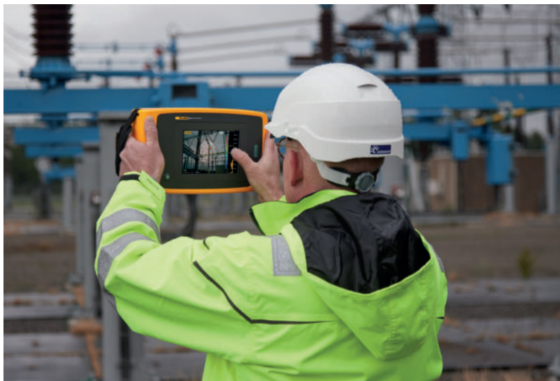
Immagine acquisita dalla telecamera acustica di precisione ii910 mentre rileva una scarica parziale in un'applicazione ad alta tensione
