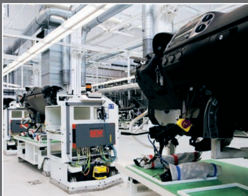
Gli Automated Guided Vehicle (AGV) collegano anche in rete le singole fasi di produzione con i processi di assemblaggio
