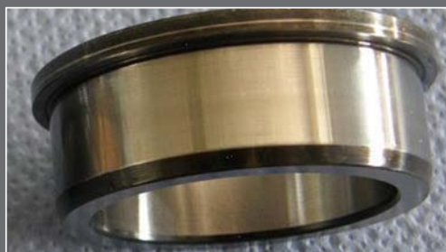
Figura 3 - Anello interno di un cuscinetto a rulli cilindrici dopo il funzionamento con uno strato sufficientemente denso di olio
