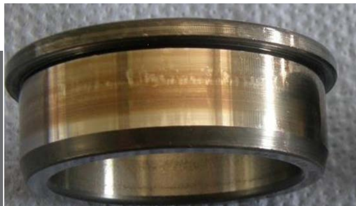
Figura 2 - Anello interno di un cuscinetto a rulli cilindrici dopo il funzionamento con un olio troppo poco denso
