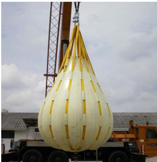
*I sacconi per prove di carico statico SO.CA.P., costruiti con tessuto sintetico ad alta resistenza impermeabilizzato con plastomeri, ed assemblati con saldature a caldo, sono una valida alternativa ai sistemi tradizionali per eseguire prove di carico statico in ottemperanza ai collaudi previsti dalle vigenti legislazioni per determinate strutture*
