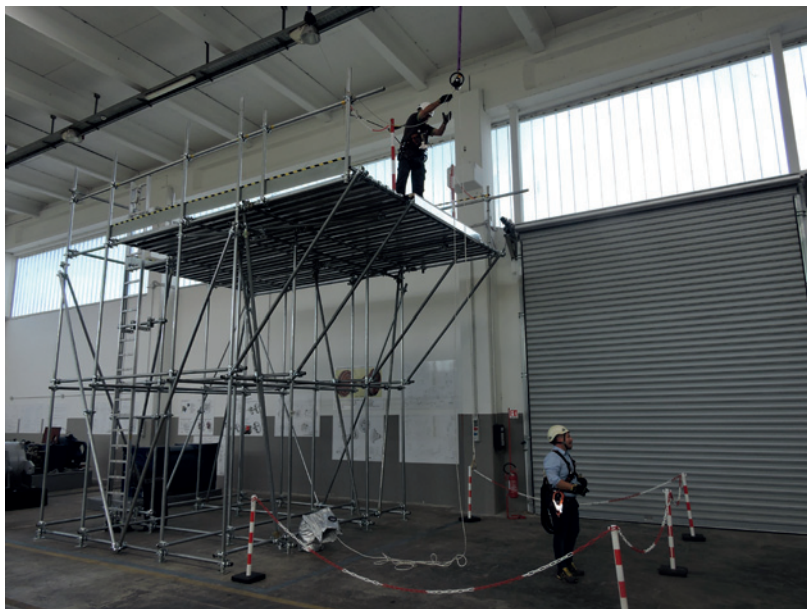
Il simulatore qui realizzato consente ai tecnici di esercitarsi a terra nelle azioni di Rescue, aumentando la frequenza di addestramento
