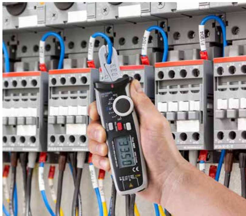
Figura 4 - I fasci di cavi stretti non sono un problema per il dispositivo VC-337, grazie alle ganasce strette e al display a sette segmenti retroilluminato
