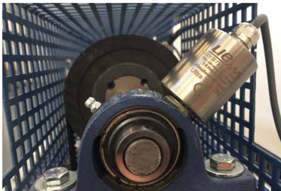
On-Trak è un sistema IIoT di monitoraggio dei cuscinetti da remoto che utilizza i sensori Ultra-Trak 750 della UE Systems. È dotato di 16 sensori e un PLC connesso in rete via wifi, ethernet o connessione SIM dati
