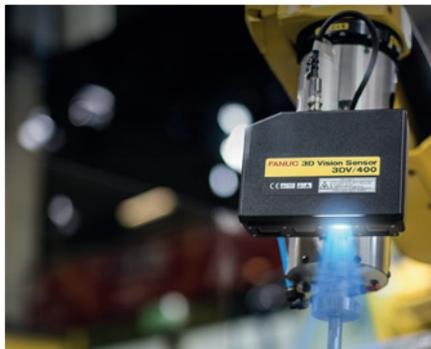
ne fissa o sull'asse 6 del robot, oppure possono essere utilizzati in combinazione sullo stesso robot. Il sensore viene pre-calibrato in fabbrica, il che permette di risparmiare tempo durante la configurazione e l'installazione.
