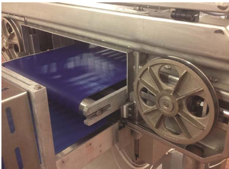
Le pulegge della lama di una macchina tagliatorte in un panificio registravano frequenti cedimenti
