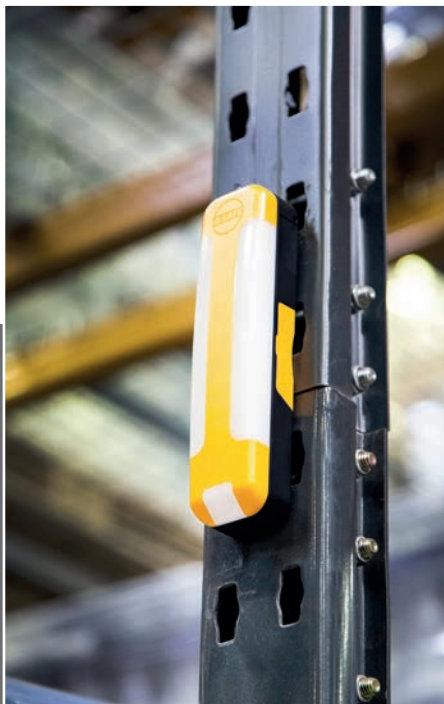
RackEye assicura un monitoraggio in tempo reale delle scaffalature e rileva istantaneamente gli impatti sulla scaffalatura
