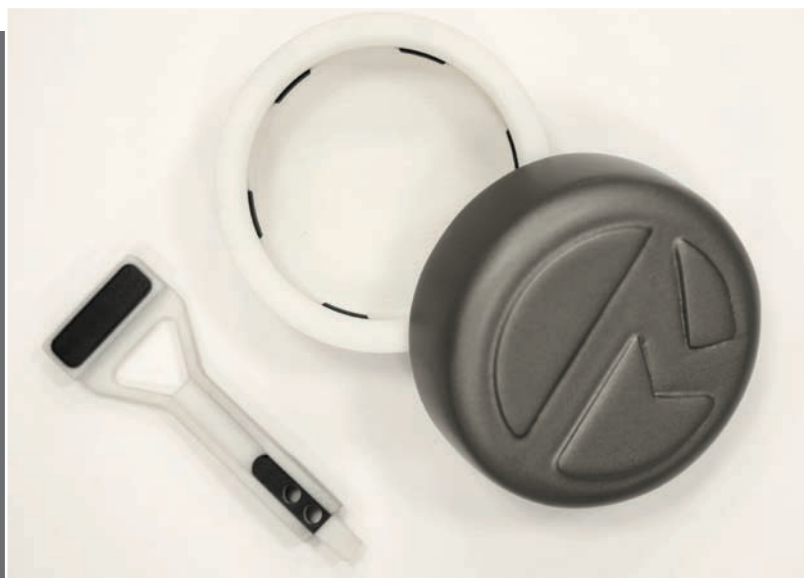
Una pinza da presa (a sinistra) e il coperchio dell’imballaggio (a destra), stampati in 3D con tecnologia Stratasys PolyJet. Stampa 3D multimateriale utilizzata per creare i componenti strutturali bianchi e le impugnature in gomma nera all’interno di un unico processo
