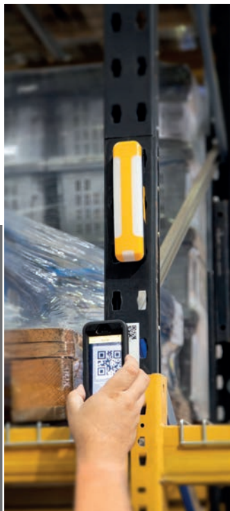
Notifica istantanea tramite app e lampeggiamento LED
