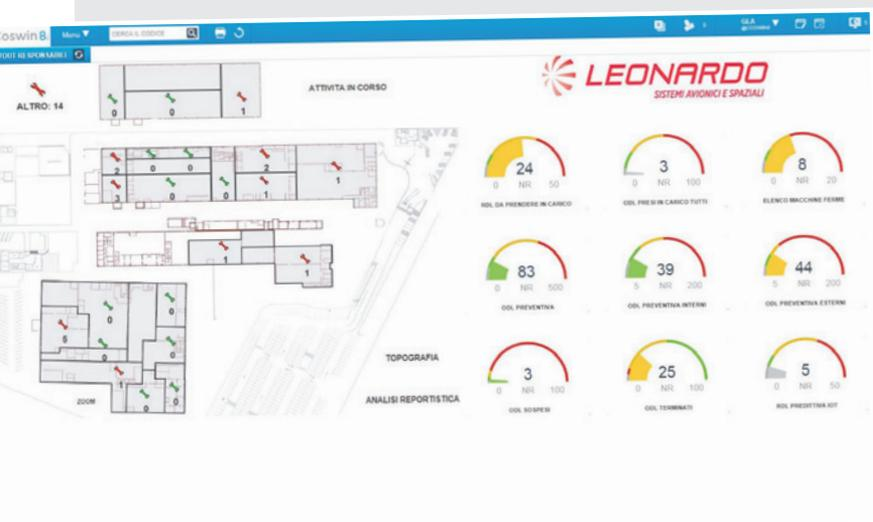
**L'utilizzo del Coswin8 ha permesso di passare da un modello di manutenzione preventiva a uno di manutenzione predittiva, costruito attraverso l'implementazione di sensoristica IoT sulle macchine non presidiate**
