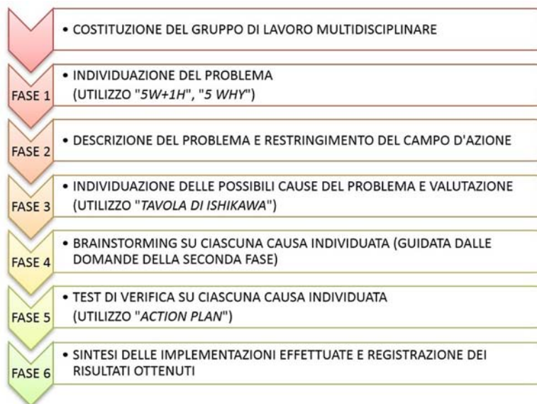
Figura 2 – Fasi di lavoro della Formal Failure Analysis (FFA)
