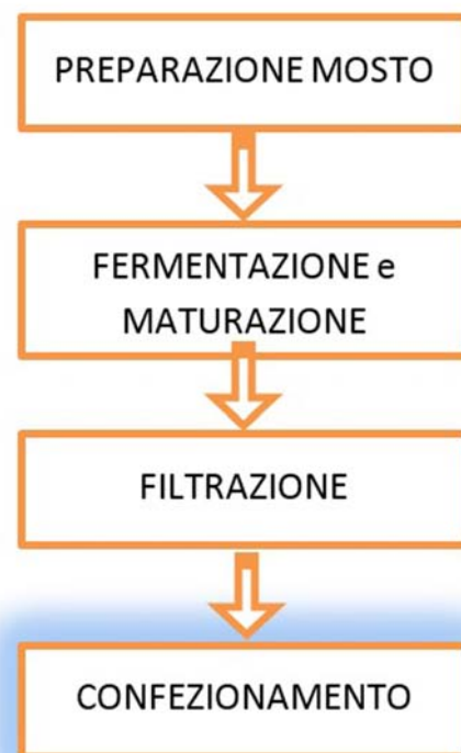
Figura 1 – Fasi del processo di produzione industriale della birra
