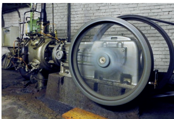
La macchina da quasi 50 anni è impiegata nel reparto di ritorcitura e binatura, in cui gestisce il funzionamento degli ugelli di umidificazione a bassa pressione
