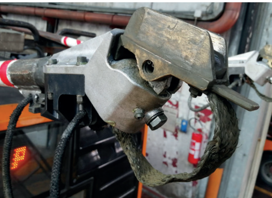
La nuova testa trolley stampata in 3D in azione. Questa parte collega il filobus ai cavi aerei di alimentazione
