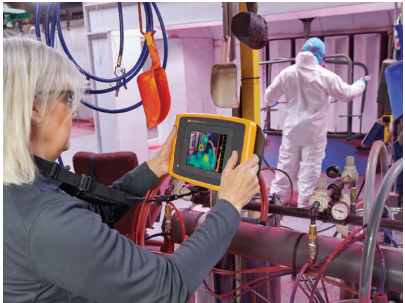
La telecamera acustica introdotta da Fluke Corporation consente agli utenti di individuare e visualizzare le perdite d'aria su uno schermo a LED in tempo reale con un processo "punta e riprendi" che non richiede l'intervento di un tecnico specializzato
