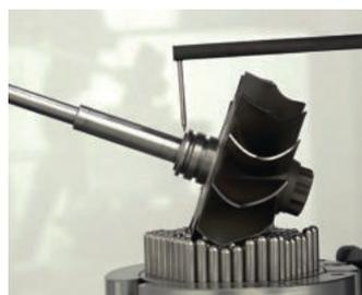
tecnologia con motore lineare che consente una rapida esecuzione del processo di misurazione ed elevata precisione di misurazione riducendo al minimo le vibrazioni e quindi l'usura, grazie all'azionamento elettromagnetico.
