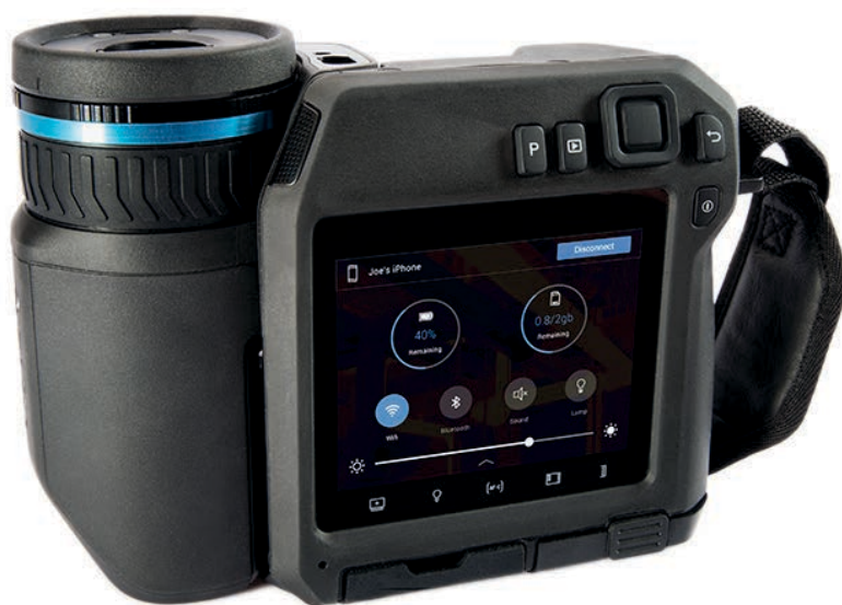
FLIR T540, con ottica 24°, può fornire letture di temperatura accurate a distanza di sicurezza dal quadro elettrico
