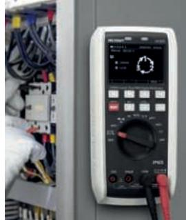
lante display transflettivo. Esso combina i vantaggi dei display a colori TFT e LC: in caso di esposizione diretta alla luce solare offre un contrasto brillante, mentre in condizioni di scarsa illuminazione si distingue per l'eccellente risoluzione ottica.
